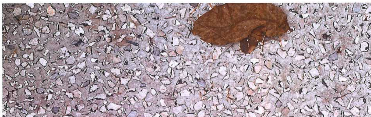
Vista ravvicinata del Confalt : superficie chiara e contrastante con l'asfalto. La levigatura permette la percezione degli inerti ed una maggiore qualità estetica.
